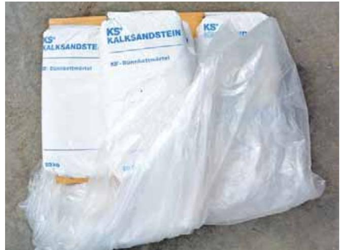
**Bild 8** Der Werk-Trockenmörtel ist vor Witterungseinflüssen zu schützen.
