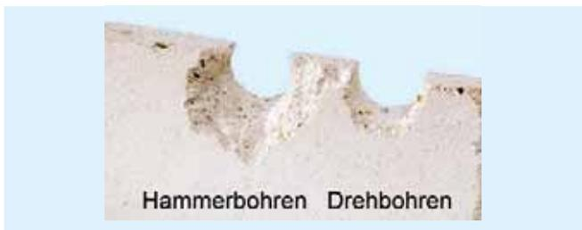
Bild 6 Unterschiedliche Vorschädigung durch Dreh- und Hammerbohren
