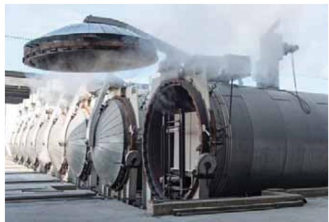
Bild 5 Das Härten der Rohlinge erfolgt in Dampf-Härtekesseln.
